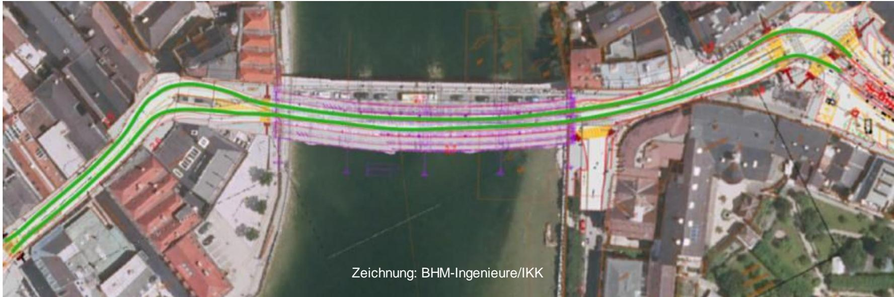
Neubau der Traunbrücke: Es ist technisch nicht sinnvoll, die bestehende Brücke, deren Belastbarkeit deutlich unter den heutigen Normenanforderungen liegt und die auf unprüfbaren, alten Holzpfahlfundamenten aus ca. 1900 steht, zu verstärken. Darüber hinaus ist die Brücke nun 55 Jahre alt und hat somit einen Großteil der zu erwartenden Nutzungsdauer von etwa 70 Jahren bereits hinter sich. Im Zuge des Neubaus werden die Abflussverhältnisse des Traunsees verbessert.
